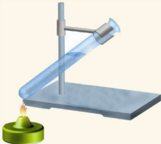
شکل (۷-۳) دستگاه تعامل سلفر و آهن در موجودیت حرارت
