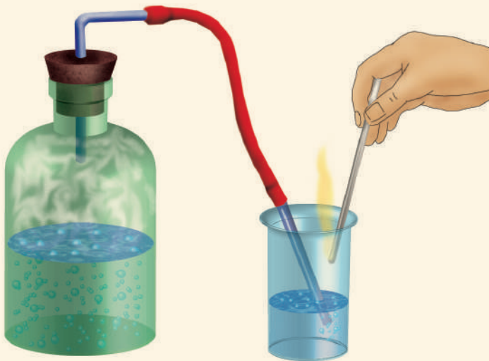
شکل (۳-۳) دستگاه جریان تعامل سنگ مرمر با تیزاب نمک
