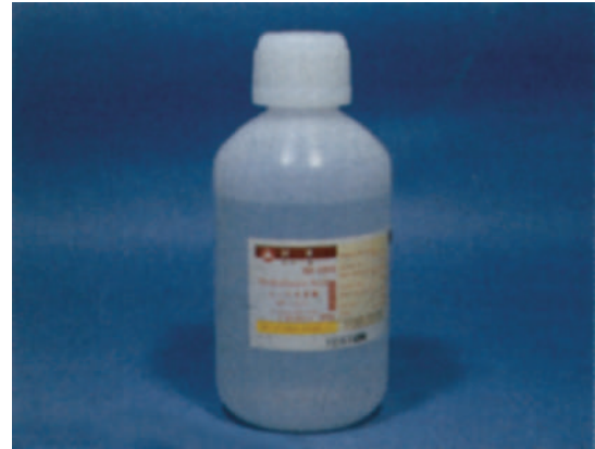
شکل (۱۲-۳) استیتیک اسید مایع بی رنگ است که در ظروف پلاستیکی نگهداری می‌شود
