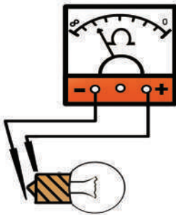
شکل (3-19) طرز اتصال اوم‌متر
